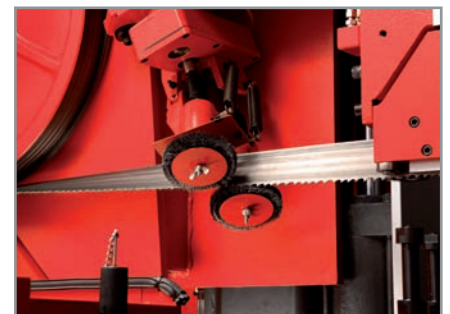
3D - система двойных щеток • Автоматическое позиционирование щеток • Система контроля износа щеток
