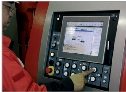
Дружественный интерфейс ЧПУ станка • Диалоговое управление • Режимы пиления для биметаллических и твердосплавных полотен
