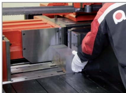
Упорная пластина для остатков • Удобная система резки остаточных заготовок
